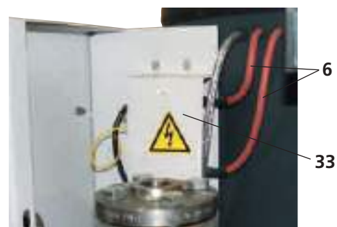
Zündtrafo mit Abdeckung Tændingstransformer med afdækning
